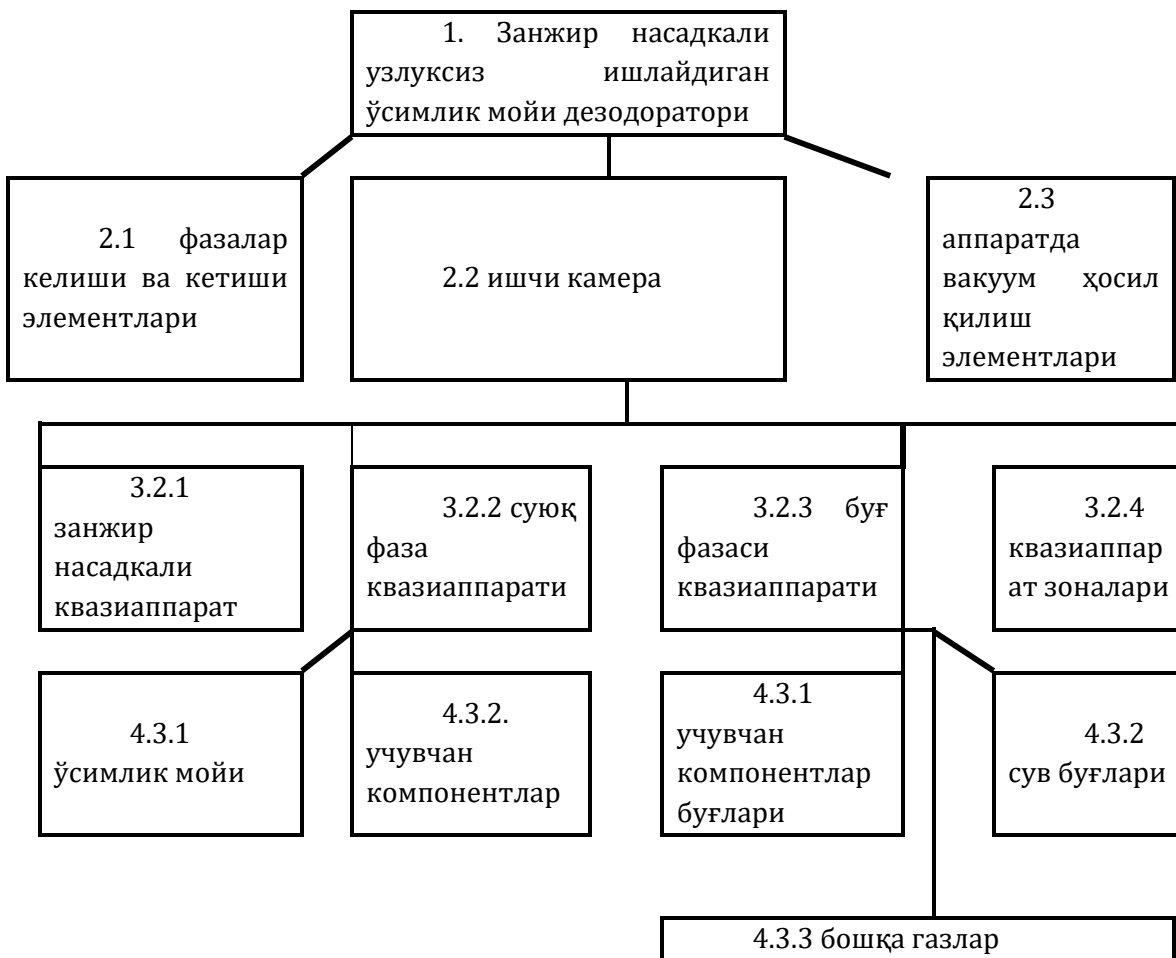
Расм-1 Занжир насадкали аппаратда ўсимлик мойини узлуксиз дезодорациялаш жараёнини иерархик структураси.
