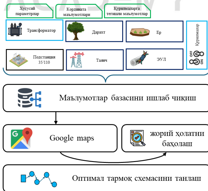
6-rasm. Optimal elektr ta'minoti sxemasi va tarmoqni baholash modulining ishlash tamoyili
