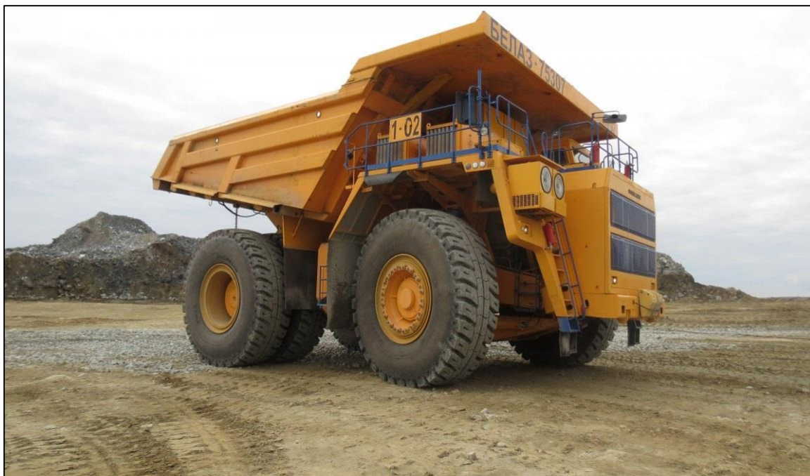
1-rasm. 220 tonna yuk ko'tarish qobilyatiga ega BelAZ 7530 rusumli avtosomasvali.
