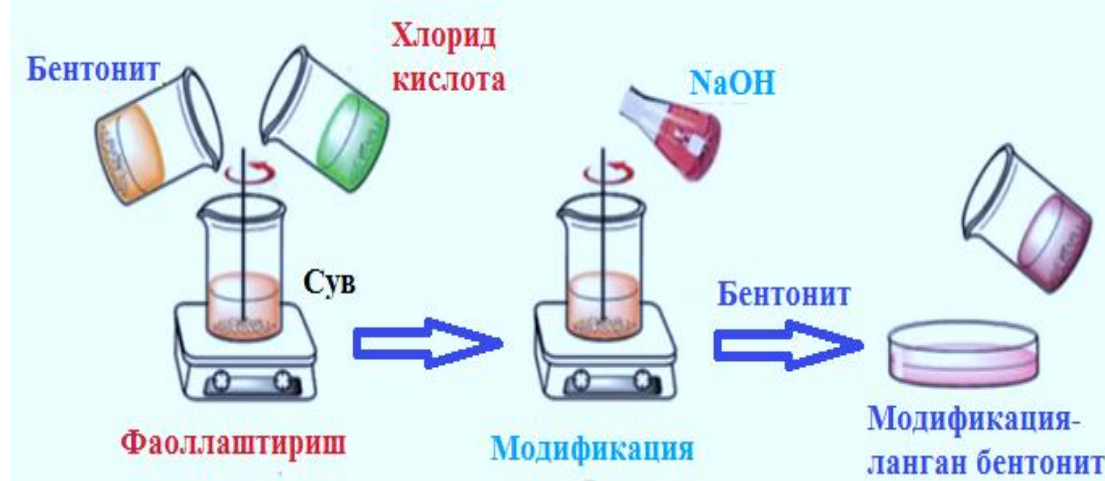
2-расм. Навбахордан келтирилган бентонитни фаоллаштириш ва модификациялаш жараёни
