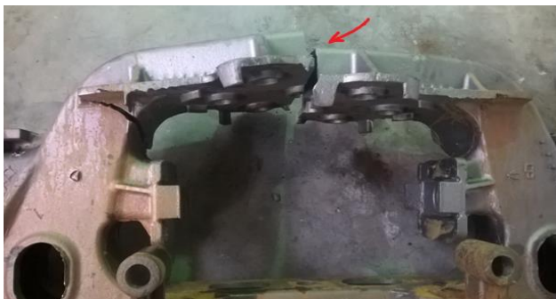
Рисунок 4 – Излом боковой рамы
