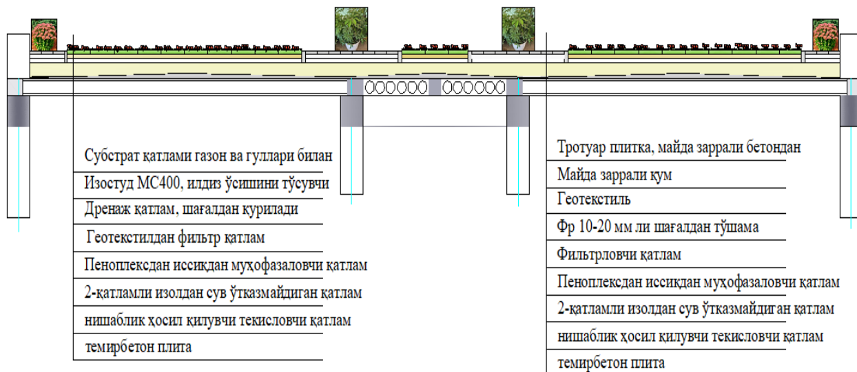
4 -rasm. Tomning turli maqsadlar uchun ajratilgan uchastkalarining konstruktiv yechimlari
