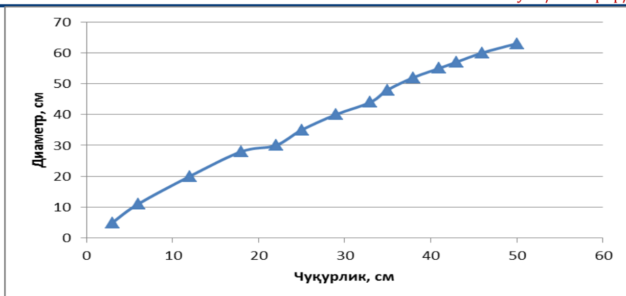
4.6.7-расм. q=1,8 л/соат сарфи учун намланишнинг эллипс контурларини геометрик параметрлари
