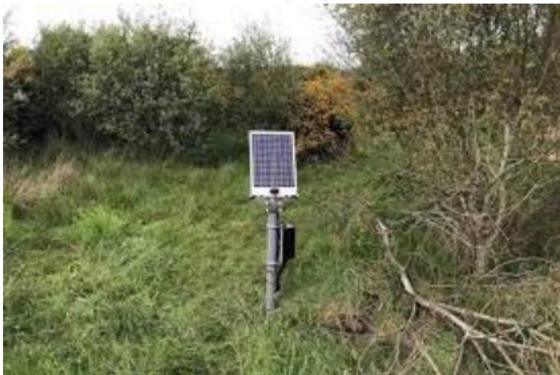
Rasm 3. Kuzatuv qudug'iga Diver qurilmasini o'rnatish
